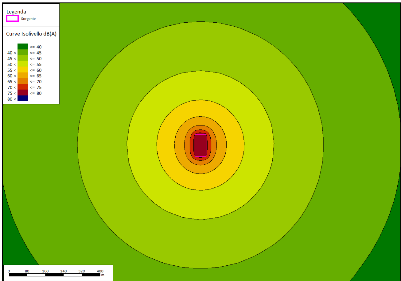
Figura 6-29 Mappatura acustica in planimetria: cantiere mobile connesso all'attività di scavo
