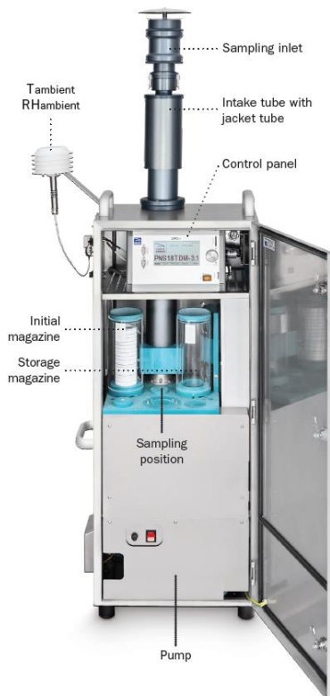
Figura 4-1 Campionatore sequenziale automatico
