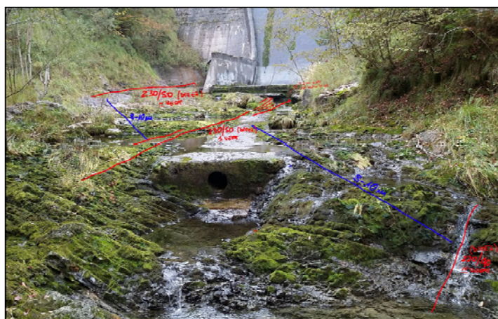
Fig.3: a valle dello scivolo, la St è sottile e divisa da fratture K2 (in rosso).
