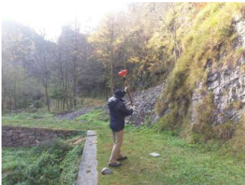
Stendimento dei n. 24 geofoni di misura e fase di energizzazione
