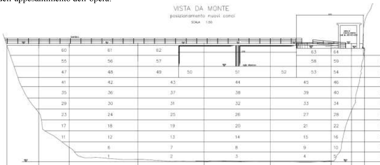
Immagine tratta dalla tavola di progetto “780-003-800-Rev.00 / Getto di appesantimento – Conci – Vista da monte – Posizionamento conci / 08.01.2018”
