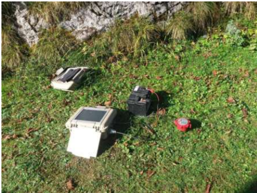
Dettaglio posizione geofono di misura e strumentazione di acquisizione dati
