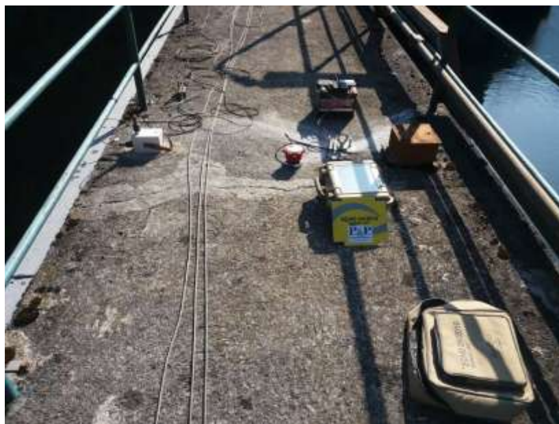
Indagini HVSR condotte sul coronamento della diga
