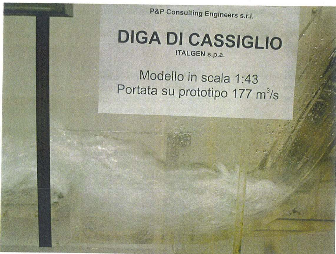
Foto 6: particolare della vasca di dissipazione (portata su prototipo di 177 \text{ m}^3/\text{s} ).
