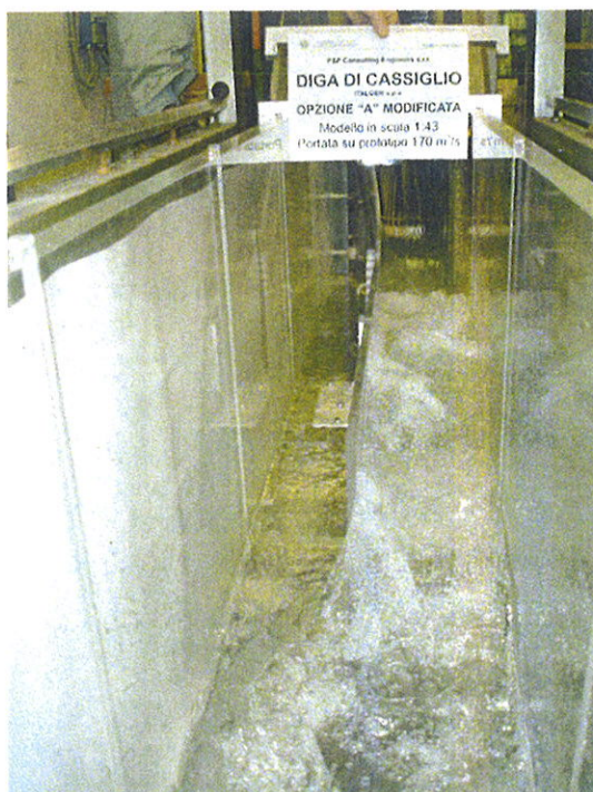
Foto 12: veduta da valle del modello in funzione con una portata su prototipo di 170 m 3 /s.
