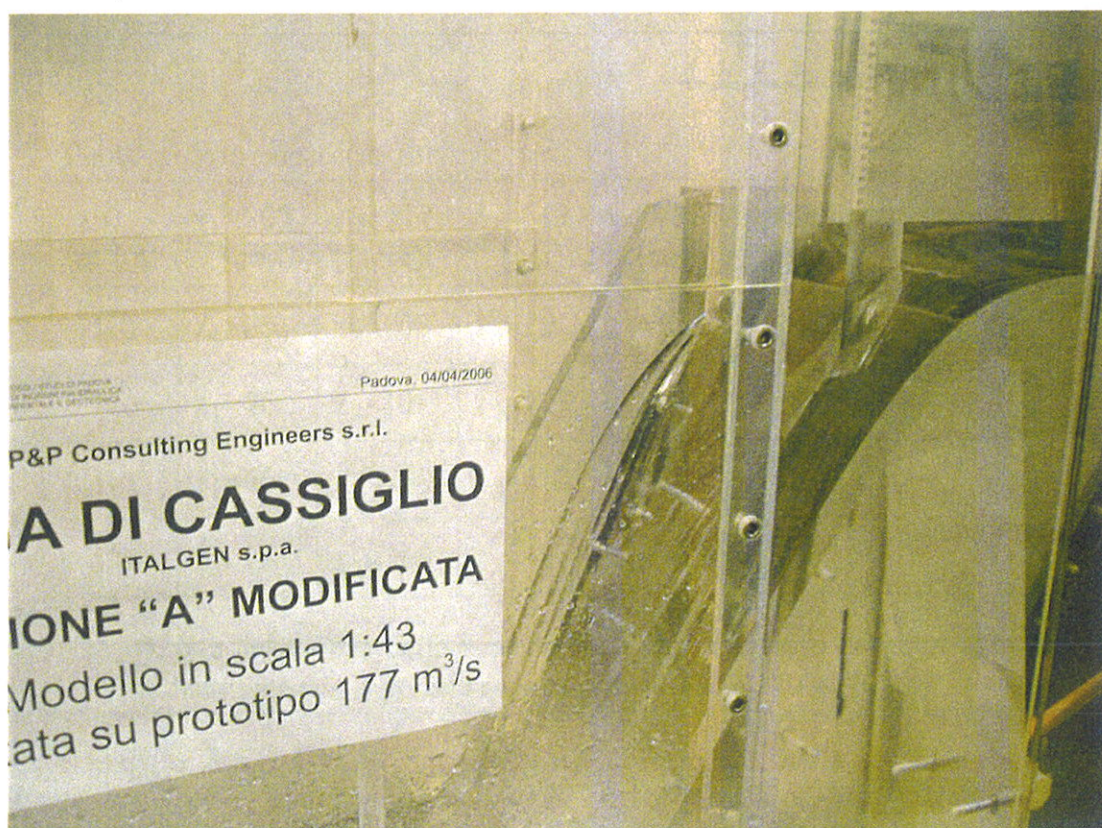
Foto 13: particolare dei disturbi della vena sullo scivolo provocati dall'attacco del muro di contenimento e dalla pila per una portata su prototipo di 177 m 3 /s.
