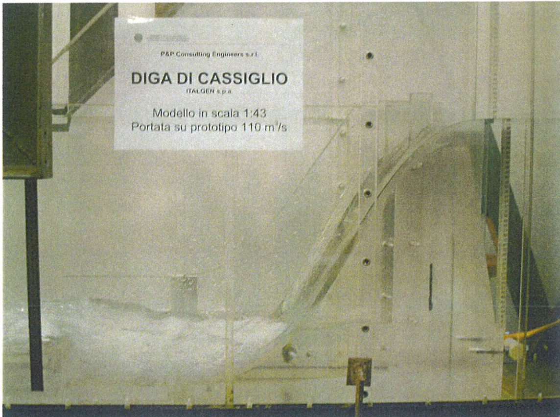
Foto 4: veduta laterale del modello in funzione con una portata su prototipo di 110 m 3 /s.
