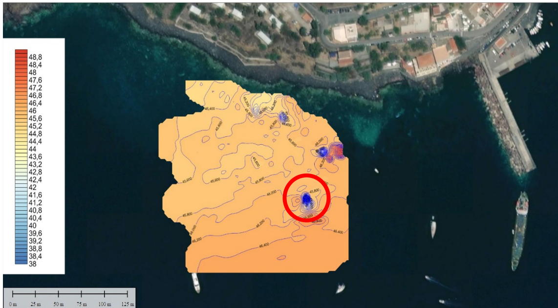
Figura 3.2 – Salina (ME): Restituzione grafica dell'indagine magnetometrica.
