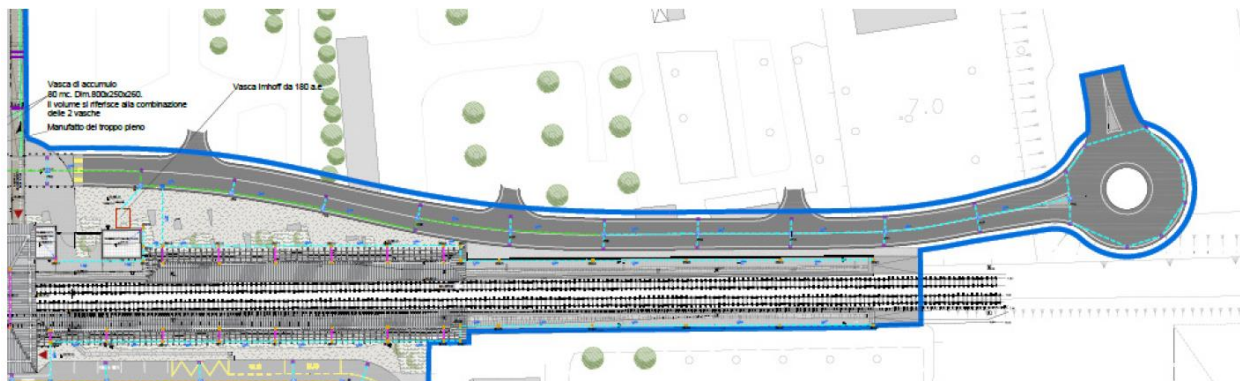
Figura 33: Schema di drenaggio nuova viabilità di Stazione
