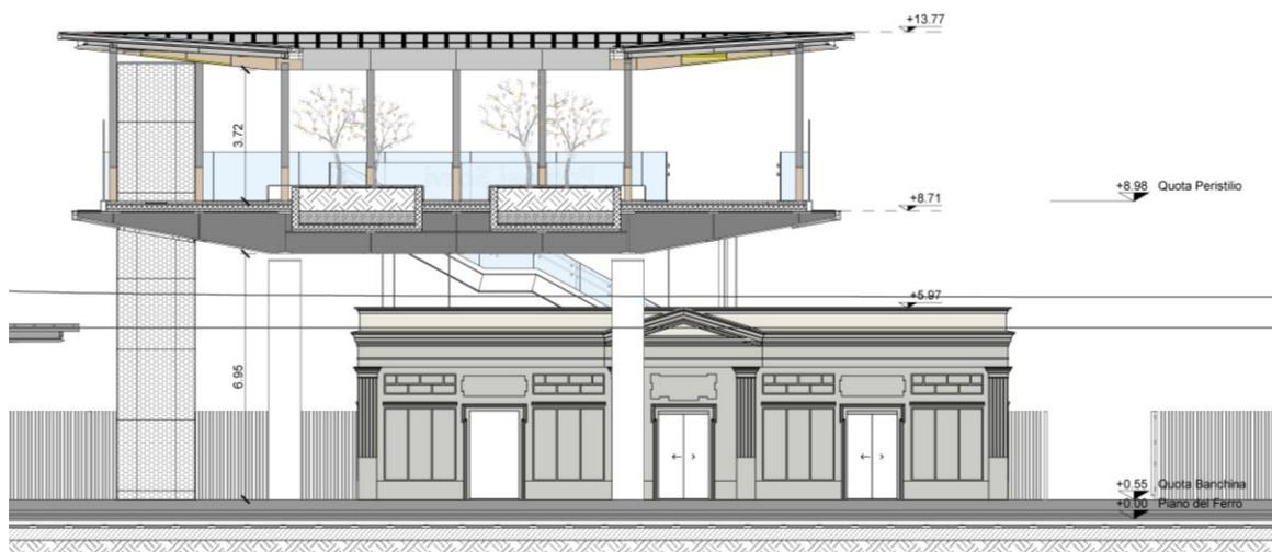
Figura 1: Sezione della piastra di collegamento
