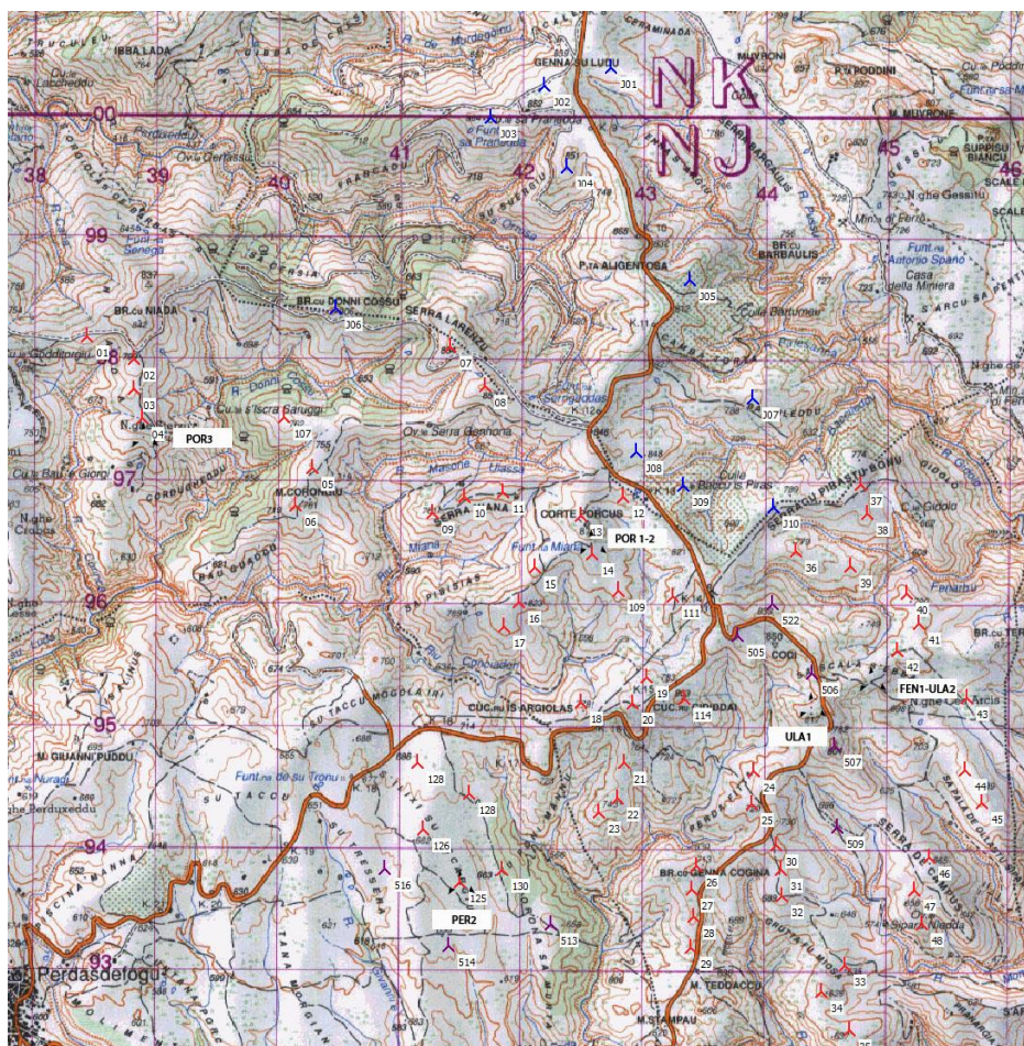
Figura 1: Layout dell’impianto Boreas proposto (▲), dell’impianto Abbila sottoposto a VIA (▲), dell’impianto esistente (▲), e dei sistemi di misura installati nel corso degli anni.
