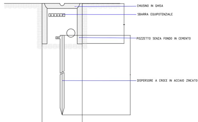
**PLINTO E POZZETTO DI DERIVAZIONE TIPO PER PALI DI ILLUMINAZIONE**
