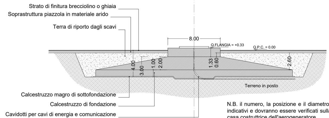
N.B. il numero, la posizione e il diametro dei dei tubi passacavi sono indicativi e dovranno essere verificati sulla base delle indicazioni della casa costruttrice dell'aerogeneratore
