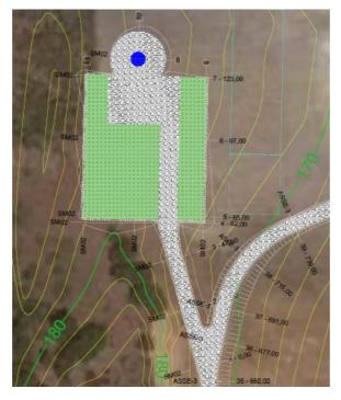
Nelle aree di installazione degli aerogeneratori è prevista la realizzazione di "piazzole" di montaggio; si tratta di aree delle dimensioni di circa 50X40 metri utili allo stoccaggio temporaneo a piè d'opera dei vari componenti degli aerogeneratori nonché per l'ubicazione della gru.
