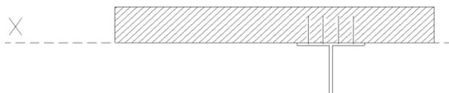
Il calcolo delle caratteristiche inerziali della trave è stato eseguito scomponendo la trave in rettangoli elementari di cui con  $h$  si indica dimensione in verticale e  $b$  in orizzontale; si è tenuto conto dell'armatura presente ad interasse "i" nel tratto di soletta collaborante.
