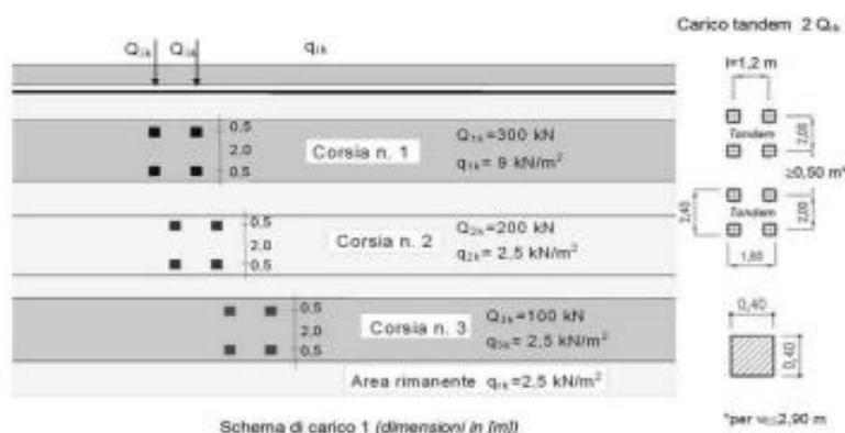
Figura 7: Schema di carico 1 - NTC18
