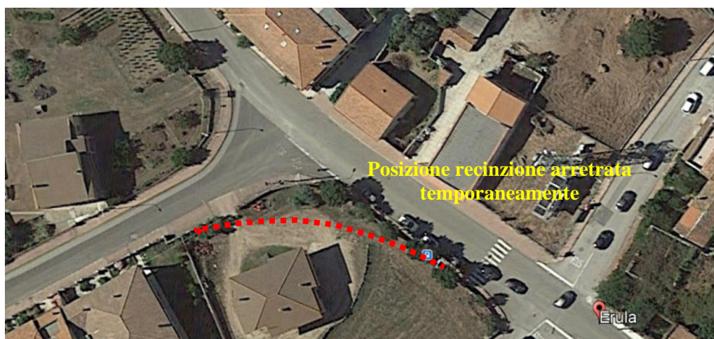
Figura 20 – Vista dell’incrocio all’interno dell’abitato di Erula tra la SP 75 e la SP 2 che richiede una temporanea modifica del muretto di recinzione del giardino di un’abitazione privata, che sarà ripristinato alla fine del trasporto delle pale eoliche.
