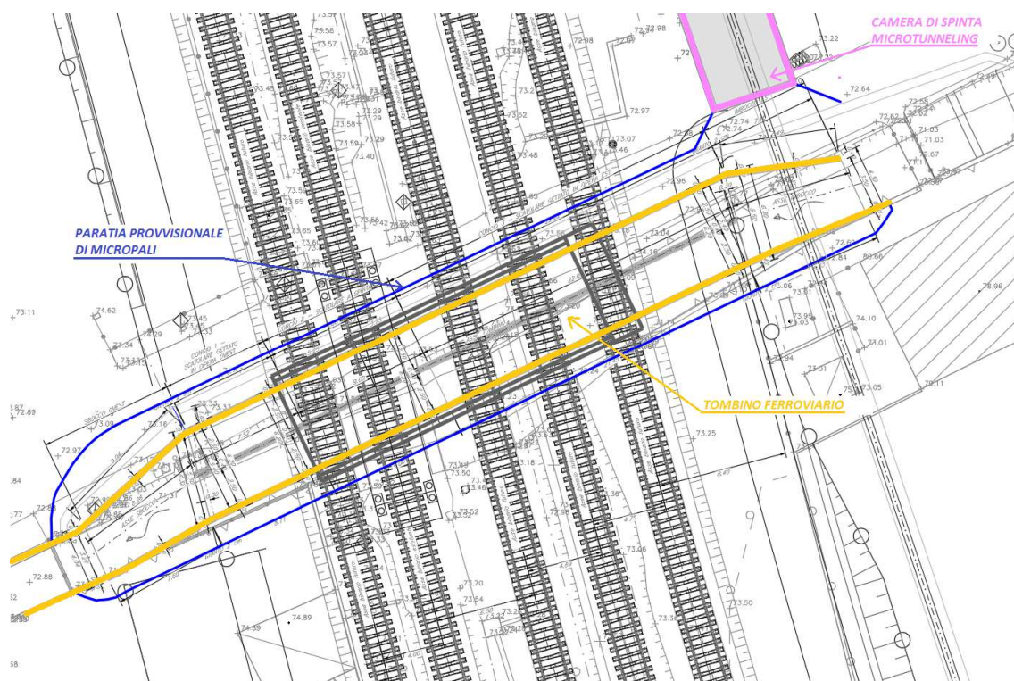
Figura 2: Vista in pianta della paratia
