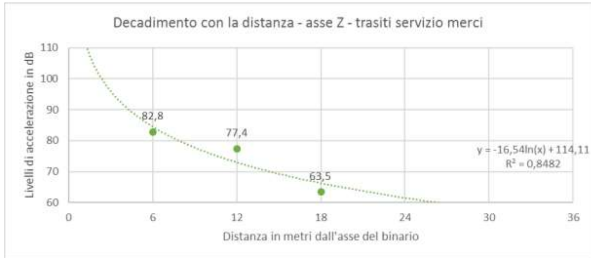
Figura 4-6 Curva di attenuazione del Leq,te in funzione della distanza dal binario, ricavata dai rilievi lungo l'asse Z, in corrispondenza della Terna 1 (6metri), della Terna 2 (12 metri) e della Terna 3 (18 metri) e relativa al totale dei transiti ferroviari connessi al servizio merci rilevati durante il periodo di osservazione.
