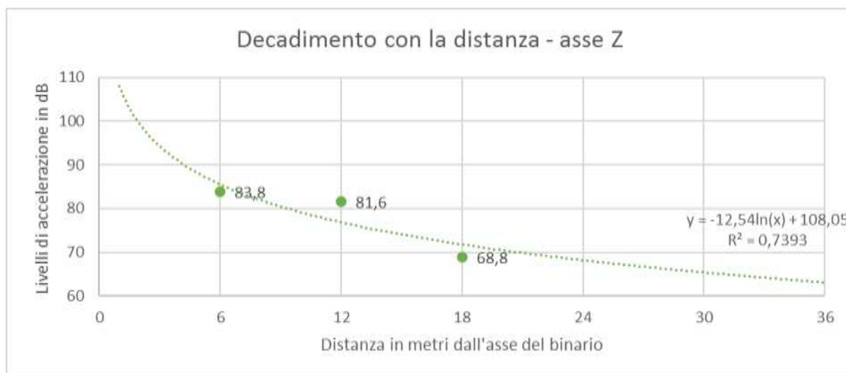
Figura 4-9 Curva di attenuazione del Leq,te in funzione della distanza dal binario, ricavata dai rilievi lungo l'asse Z, in corrispondenza della Terna 1 (6metri), della Terna 2 (12 metri) e della Terna 3 (18 metri) e relativa al totale dei transiti ferroviari rilevati durante il periodo di osservazione.
