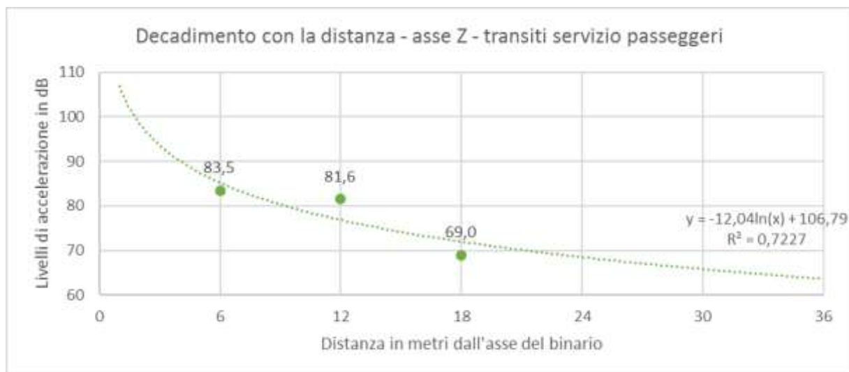
Figura 4-3 Curva di attenuazione del Leq,te in funzione della distanza dal binario, ricavata dai rilievi lungo l'asse Z, in corrispondenza della Terna 1 (6metri), della Terna 2 (12 metri) e della Terna 3 (18 metri) e relativa al totale dei transiti ferroviari connessi al servizio passeggeri rilevati durante il periodo di osservazione.
