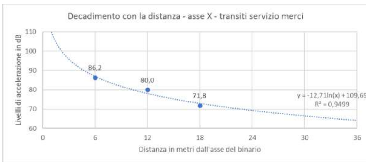
Figura 4-4 Curva di attenuazione del Leq,te in funzione della distanza dal binario, ricavata dai rilievi lungo l'asse X, in corrispondenza della Terna 1 (6metri), della Terna 2 (12 metri) e della Terna 3 (18 metri) e relativa al totale dei transiti ferroviari connessi al servizio merci rilevati durante il periodo di osservazione.
