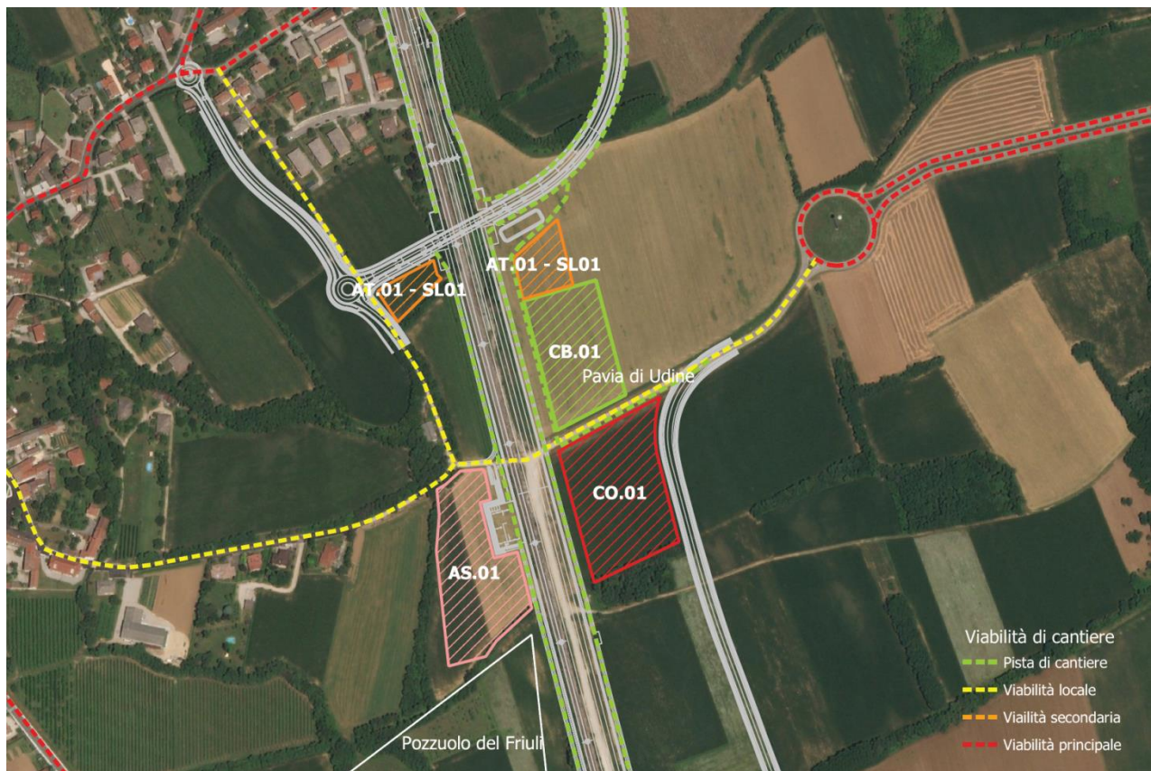
Figura 19- Aree di cantiere a sud di Lumignacco
