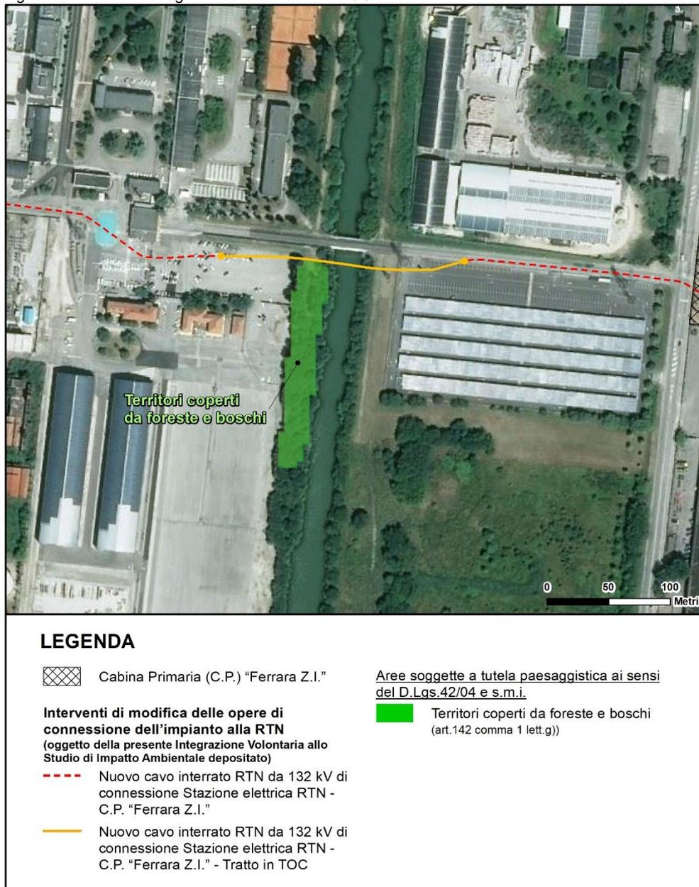
In tal modo è possibile realizzare il cavidotto evitando lo scavo della trincea dalla superficie, ed escludere qualsiasi interferenza diretta tra il cavidotto e le specie arboree tutelate, che non saranno in alcun modo coinvolte dalla realizzazione e dall'esercizio dell'intervento.
