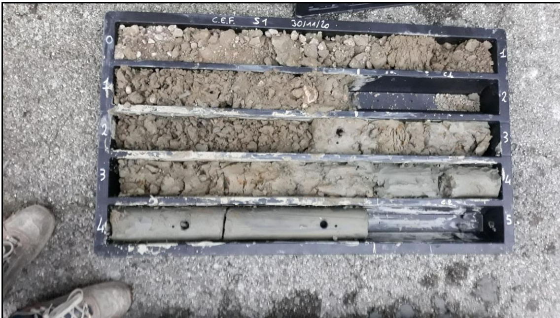
SONDAGGIO S1 da m 0 a m5
