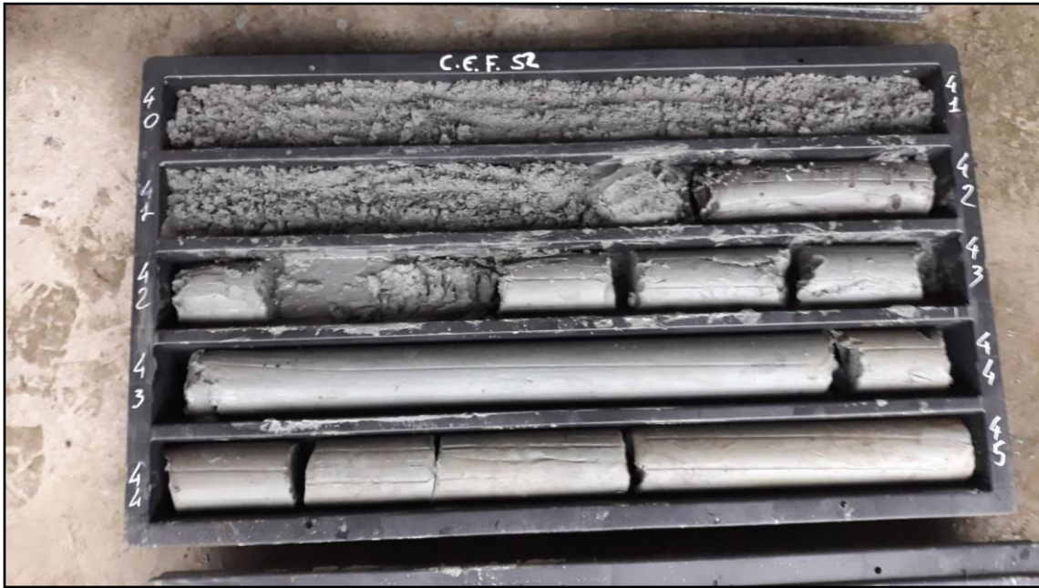
SONDAGGIO S2 da m 40 a m 45
