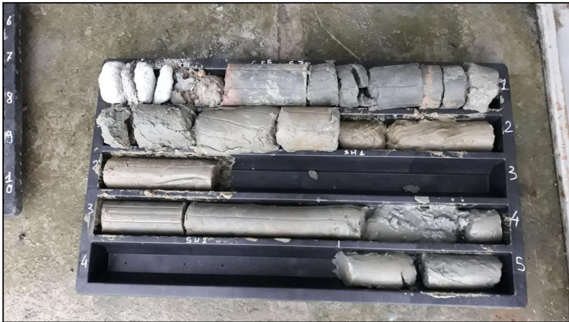
SONDAGGIO S3 da m 0 a m5
