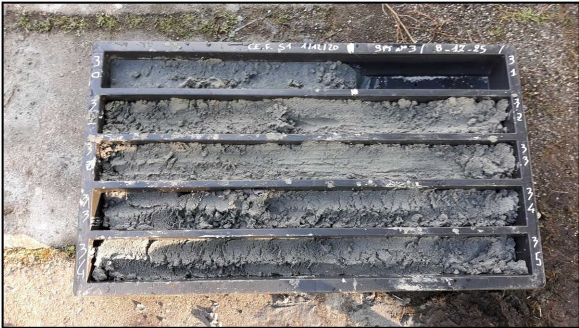
SONDAGGIO S1 da m 30 a m 35
