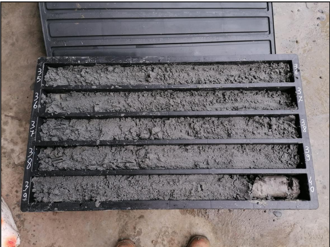
SONDAGGIO S3 da m 35 a m 40
