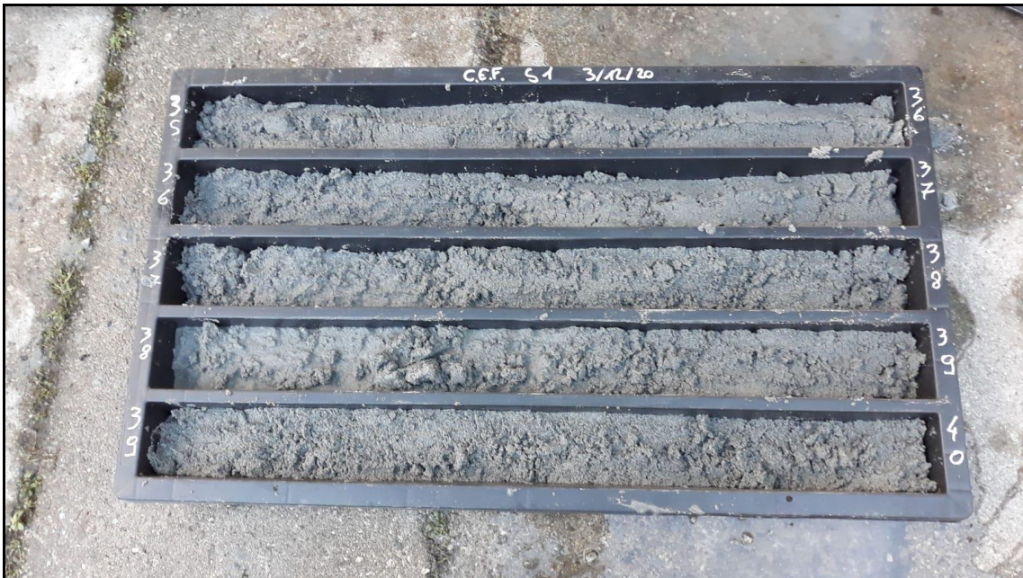
SONDAGGIO S1 da m 35 a m 40
