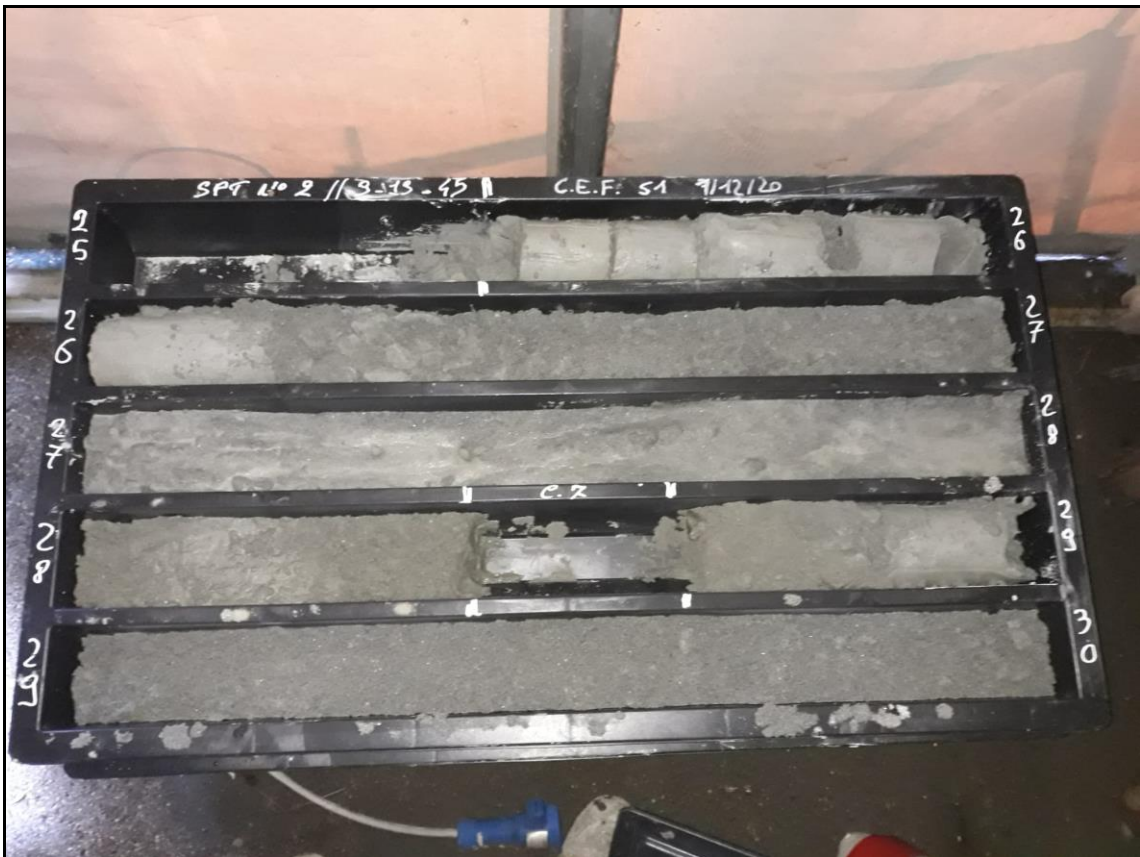
SONDAGGIO S1 da m 25 a m 30
