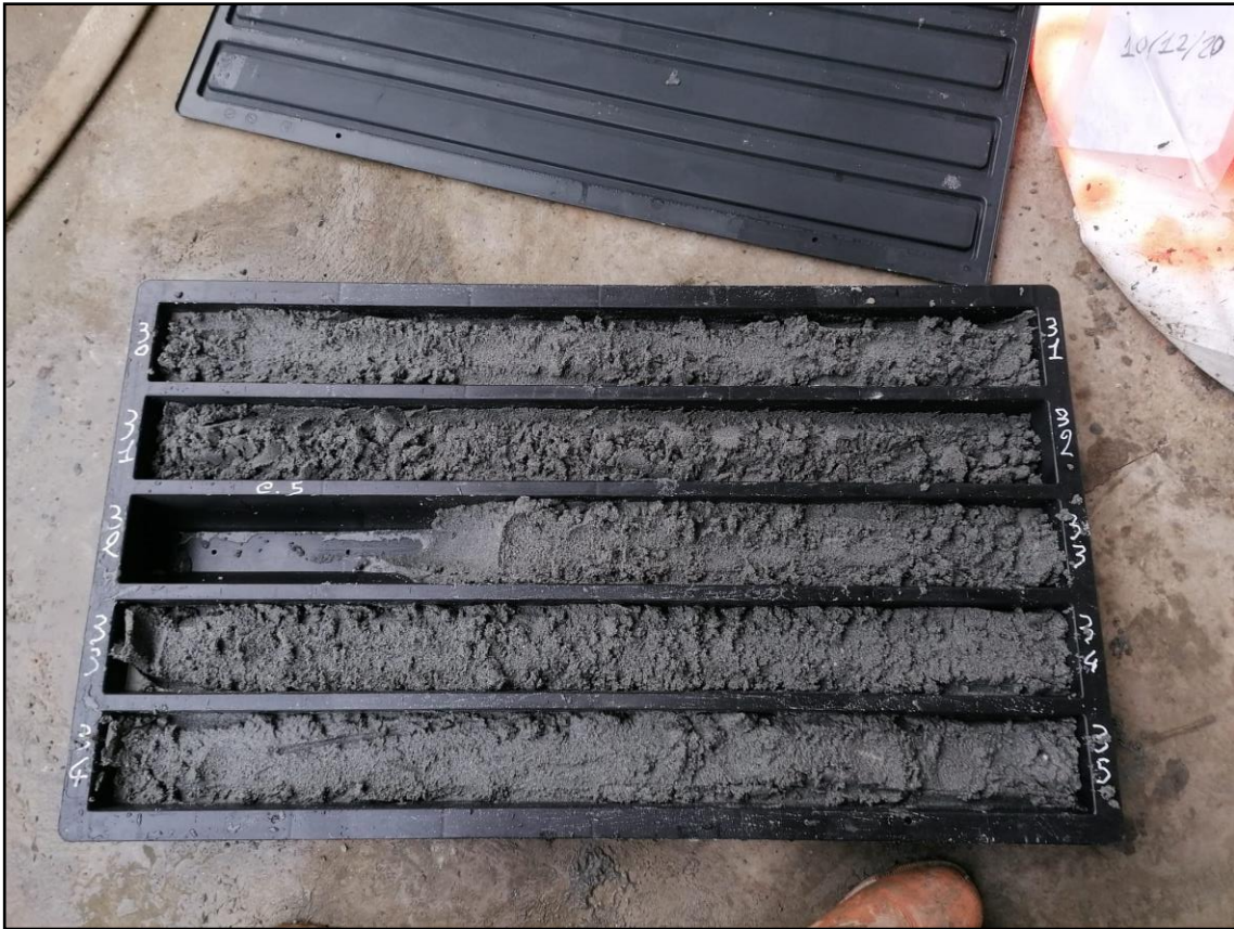
SONDAGGIO S3 da m 30 a m 35
