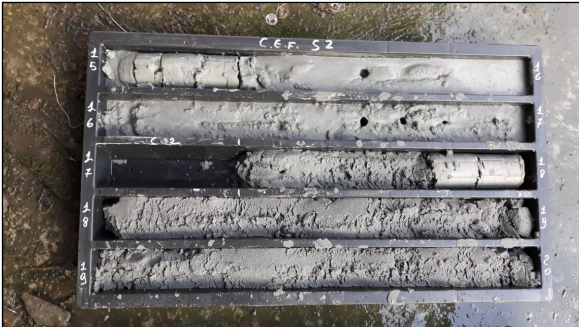
SONDAGGIO S2 da m 15 a m20
