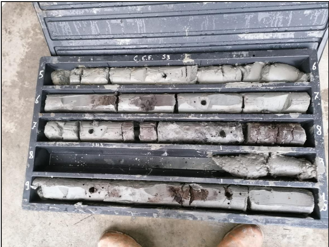
SONDAGGIO S3 da m 5 a m10
