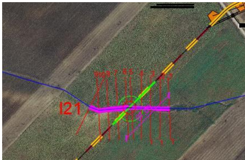
Figura 21 - individuazione de'interferenza del reticolo idrografico la strada di cantiere e il cavidotto MT interrato, e rappresentazione delle aree allabili nelle condizioni ante operam e post operam.
