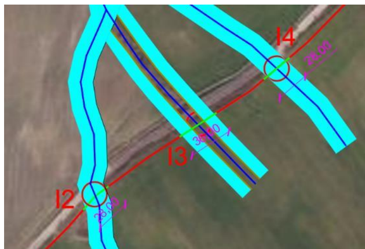
Figura 8 - Individuazione de'interferenza del reticolo idrografico con il cavidotto MT esterno, in rosso il cavidotto interrato con tecnica di scavo a cielo aperto, in giallo il tratto di cavidotto da eseguire con tecnica di scavo controllata (TOC)
