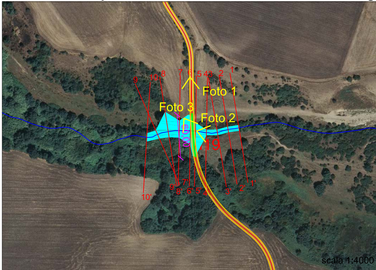
Planimetria su fotopiano con individuazione dell'area allagabile determinata in regime di moto permanente Tr 200 anni
