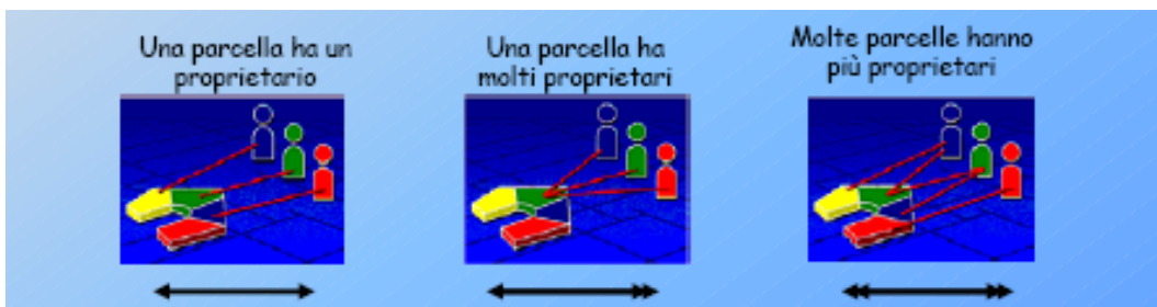
Fig. 6 – La figura illustra i tre tipi di cardinalità: a) 1 a 1, b) 1 a molti c) Molti a molti
