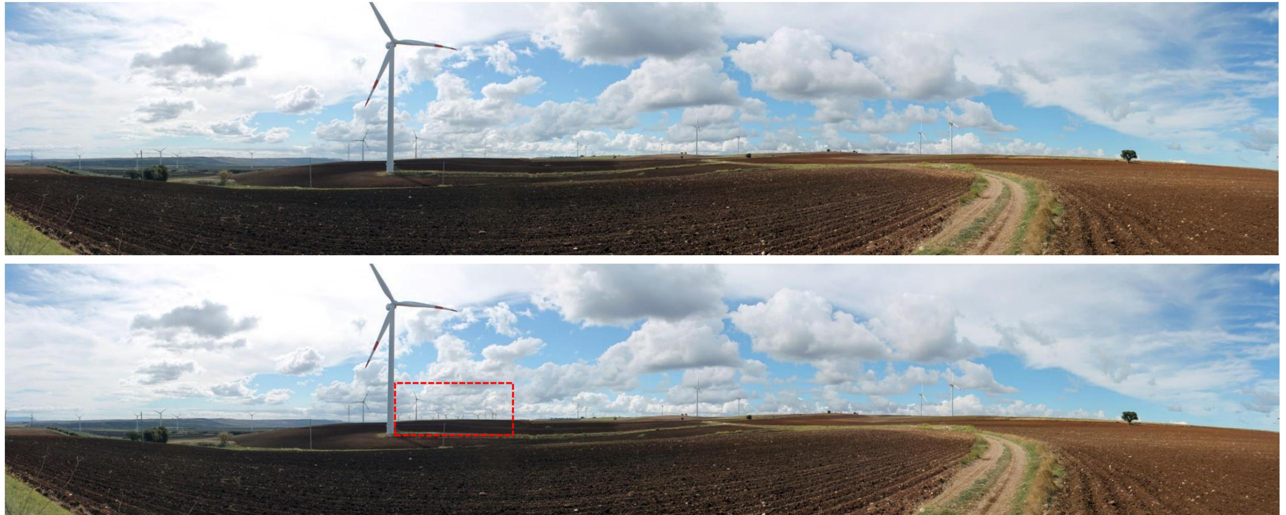
Figura 6.10 \_ PAN 02 \_ Confronto tra stato di fatto (in alto) e progetto \_ Vista a circa 4,8 km di distanza dagli aerogeneratori in progetto (nel riquadro rosso)
