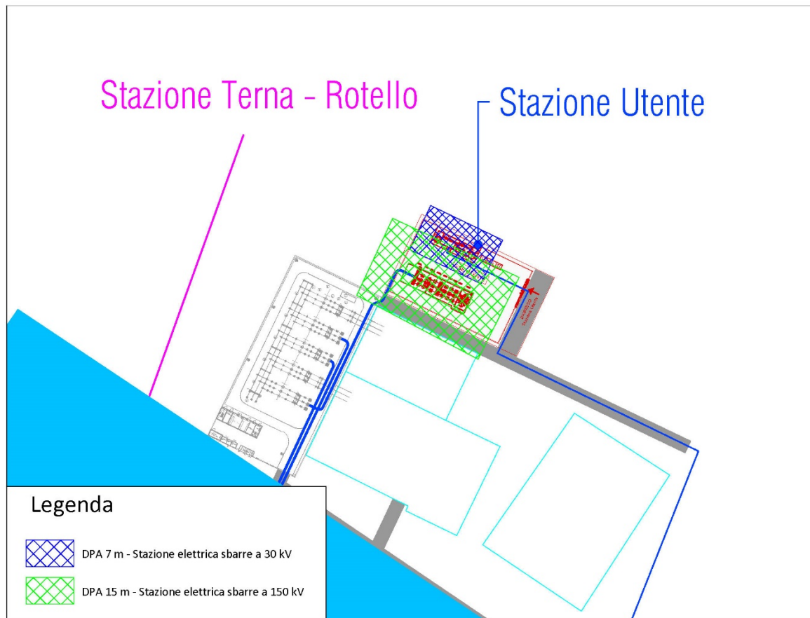
Figura 15 Rappresentazione grafica della DPA stazione elettrica 30/150 kV.
