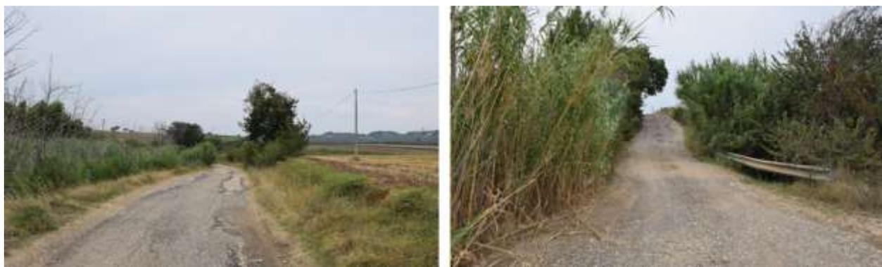
*Fotografia n. 9 – Attraversamento del cavidotto sul Canale Maddalena (reticolo di connessione della RER) lungo strada comunale Maddalena Ischia. Il cavidotto attraversa il canale lungo la strada asfaltata esistente. Il canale è superato con TOC.*
