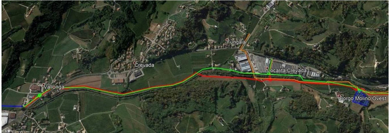
Fig. 5 Stralcio foto satellitare con indicate i tracciati (in rosso metanodotto in progetto, in verde metanodotto esistente da dismettere, in blu metanodotto in esercizio)
