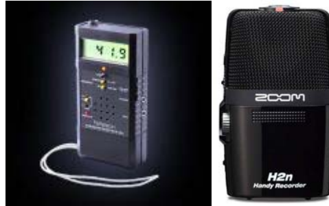
Figura 2. Strumentazione utilizzata: Bat detector D240x e collegato a un registratore digitale.
