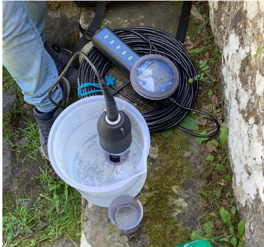
Figura 2.1b Misura dei Parametri Fisico chimici attraverso l'utilizzo di sonda multiparametrica
