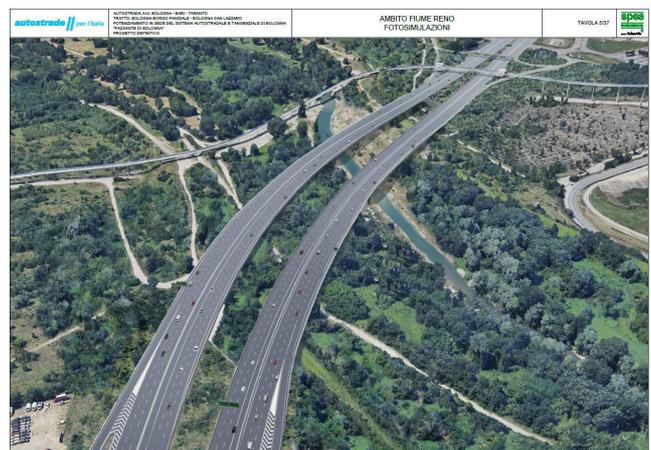
Il progetto prevede una variante plano-altimetrica dell'attuale tracciato con creazione di una "varice".
