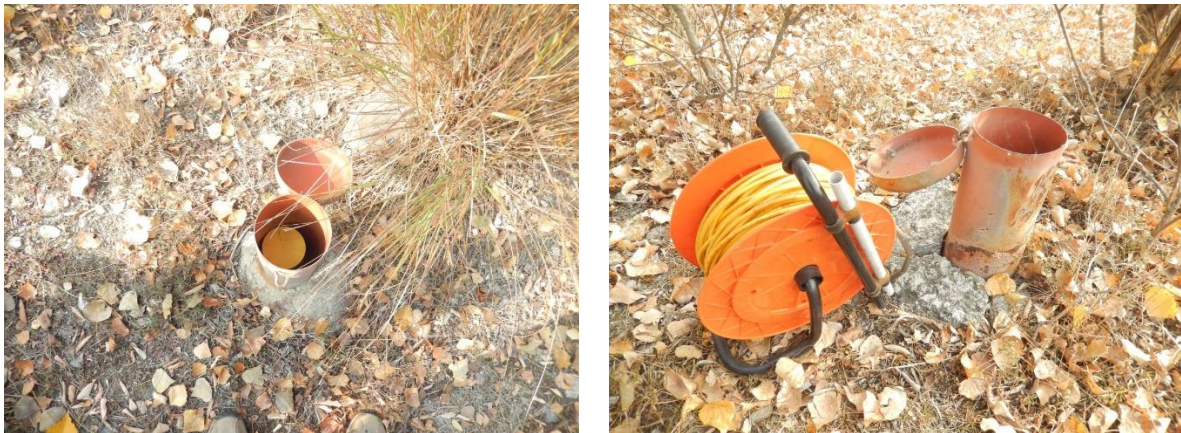
Figura 35 – Piezometri in sito
