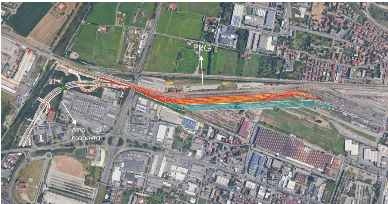
Nell'immagine viene riportata a sinistra l'asta di Manovra di 750m e le due viabilità, mentre in rosso vengono riportati i lavori di PRG.
