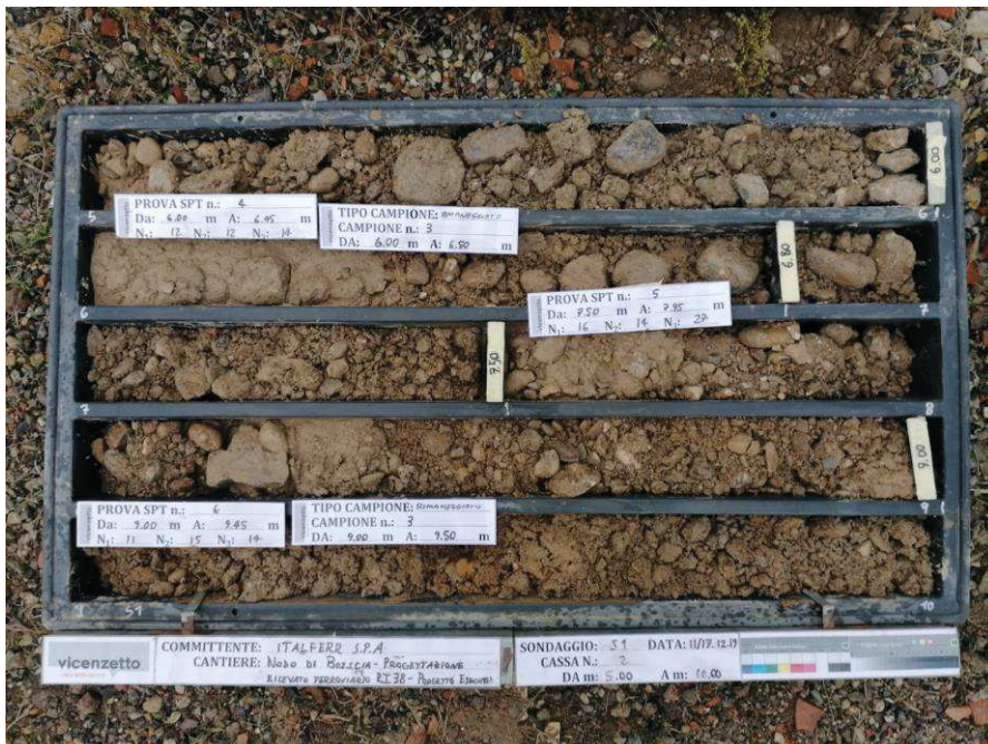
Figura 4 - Sondaggio S1, profondità 5,00-10,00m.
