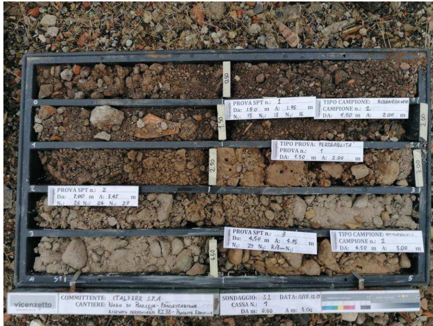
Figura 3 – Sondaggio S1, profondità 0,00 -5,00m.
