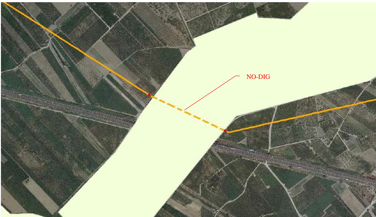
Figura 3.14 – Particolare area SIC Valle Ofanto, Lago di Capaciotti in corrispondenza della condotta in progetto. In evidenza la porzione a farsi mediante tecnica no-dig interferente con l'area SIC
