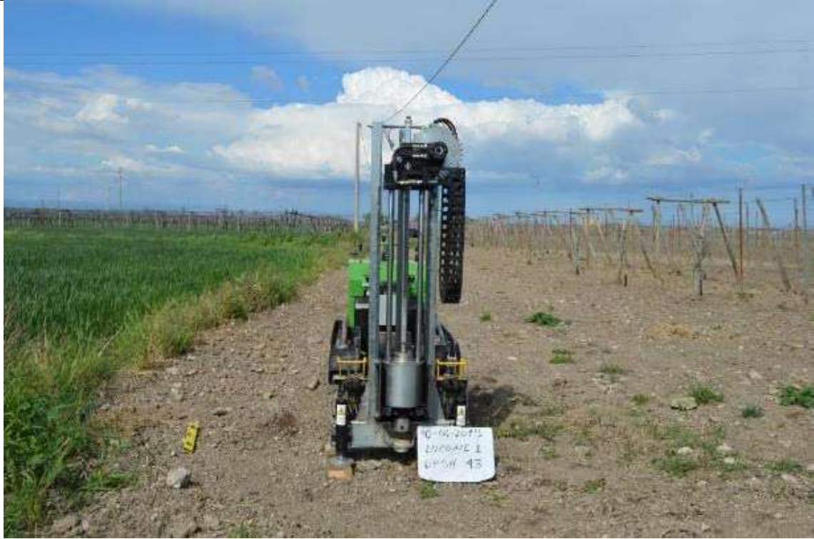
Ubicazione del penetmetro
