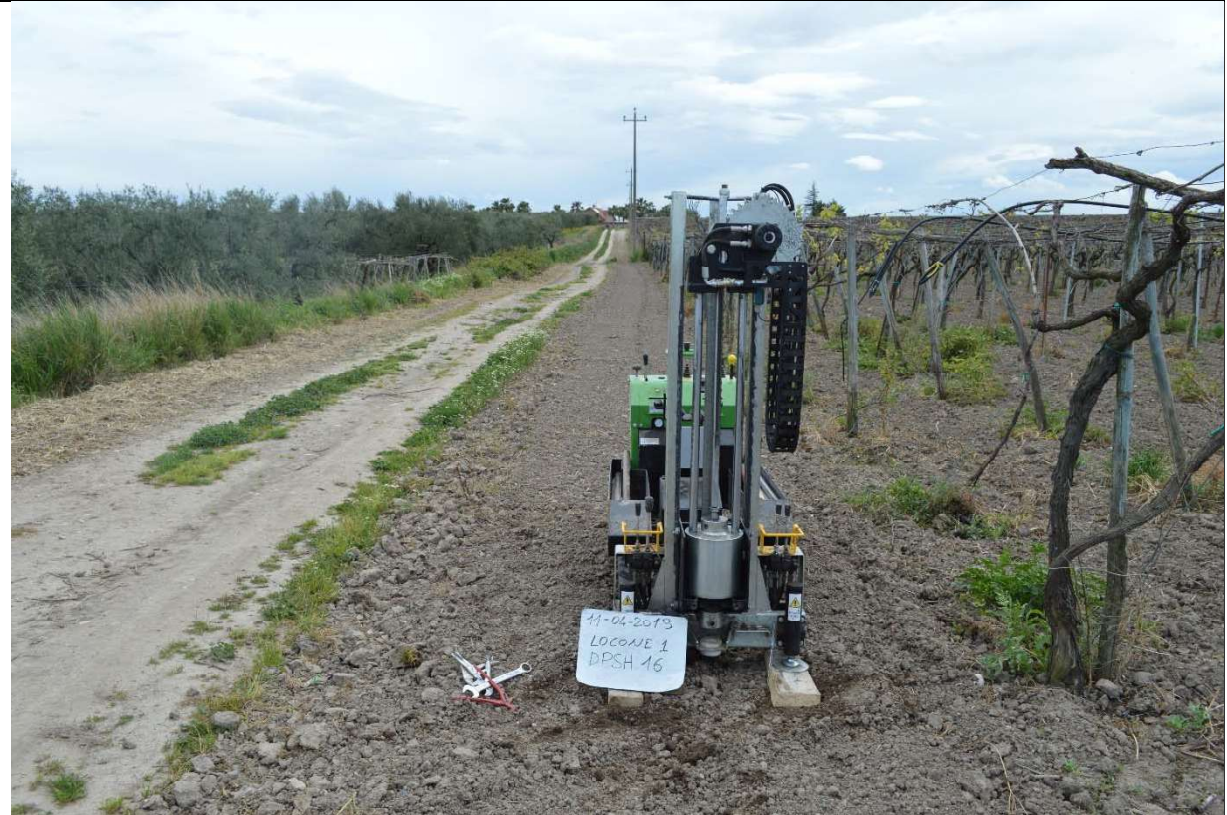
Ubicazione del penetrometro
