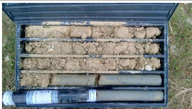
SG.11, cassetta catalogatrice da 10.0 a 15.0 metri
