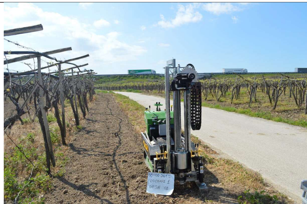
Ubicazione del penetmetro
