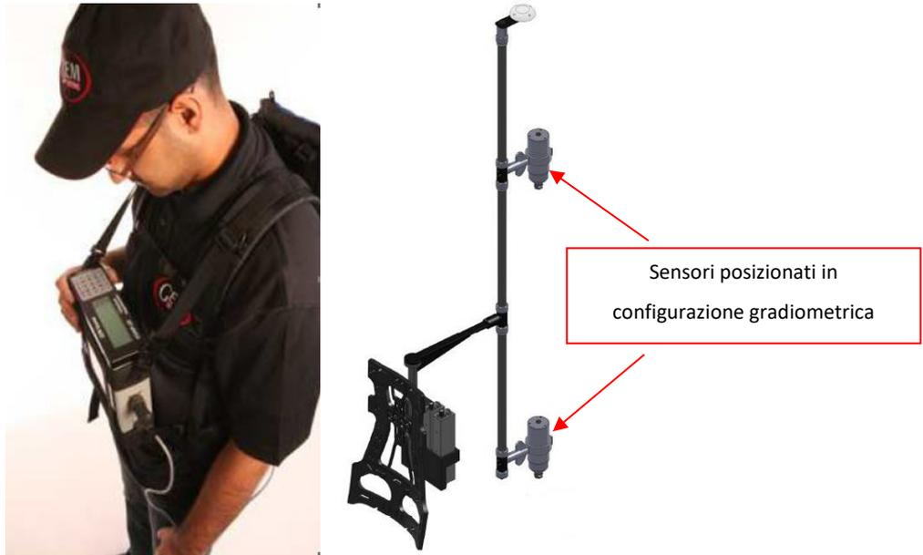
Fig.5 Magnetometro a pompaggio ottico ai vapori di Potassio modello GSMP-35
