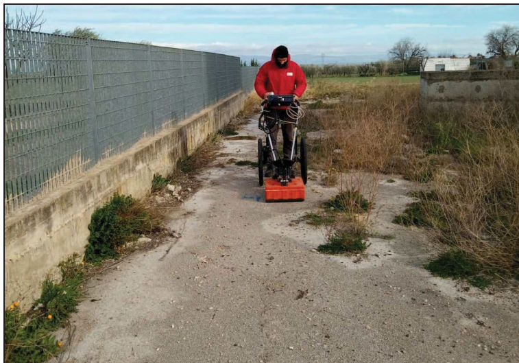
Foto 1 - Acquisizione georadar postazione num 1.
