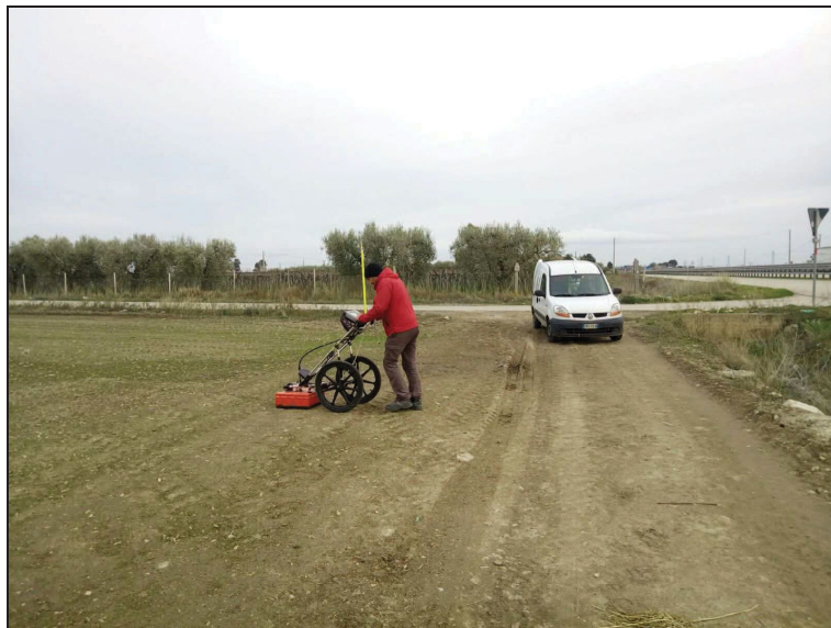
Foto 6 - Acquisizione georadar postazione num 9.
