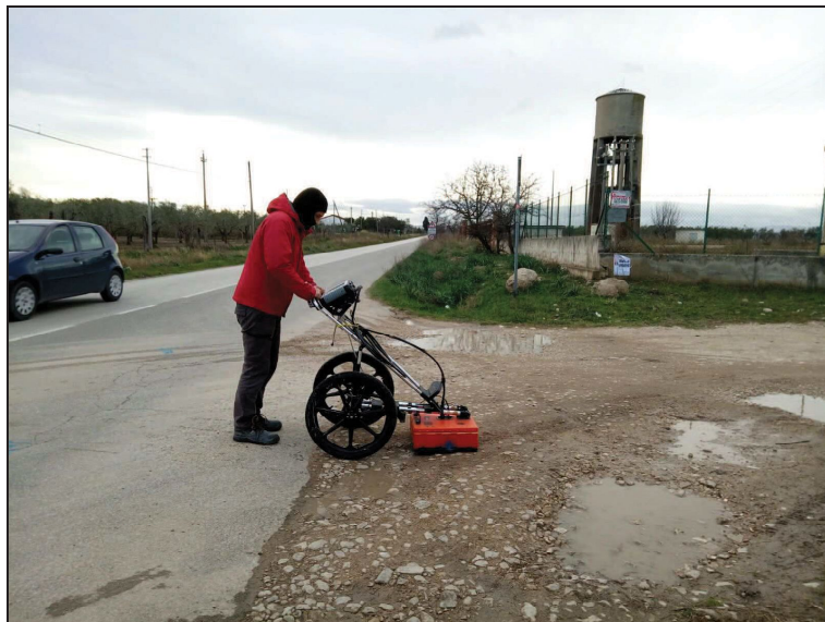
Foto 5 - Acquisizione georadar postazione num 7.
