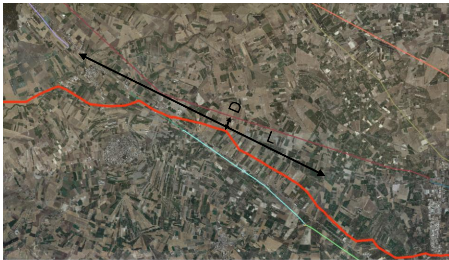
Figura 8 - Parallelismo Locone II Lotto con Linea A.T. Foggia RT – Cerignola RT (23006G1)
