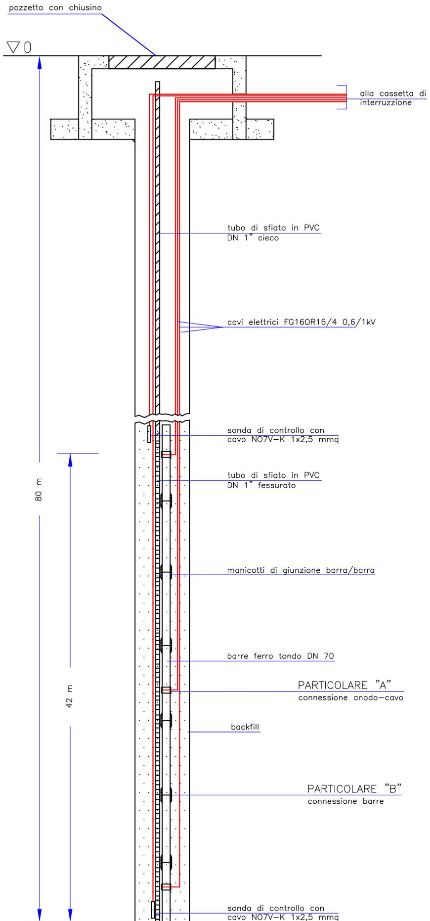
ELETTRODO DI RIFERIMENTO AL  $\text{Cu}/\text{CuSO}_4$  PER INSTALLAZIONE PERMANENTE
