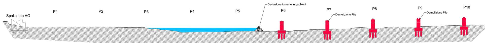
Deviazione torrente in sinistra e demolizione pile nella parte in asciutto
