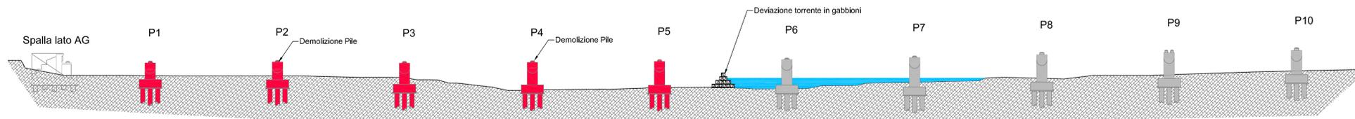
Deviazione torrente in destra e demolizione pile nella parte in asciutto
