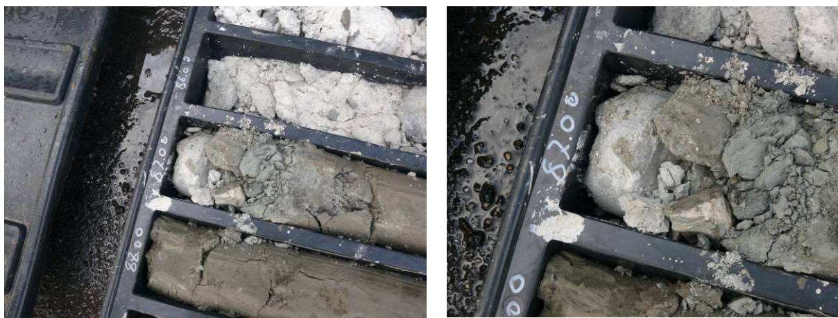
Fig. 2.2 – Particolare della carota (a dx ingrandimento) in cui avviene il passaggio tra le breccie calcaree e le argille marnose a circa 87 m.
