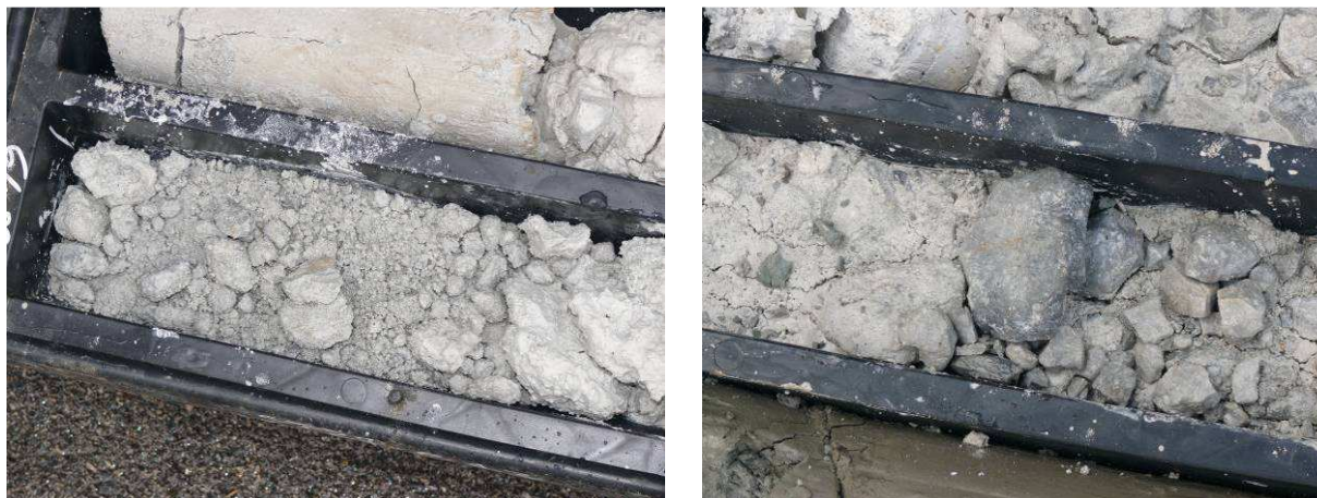
Fig. 2.1 – Confronto tra le breccie calcaree prelevate a circa 64 m (a sn) e a 86 m (a dx).
