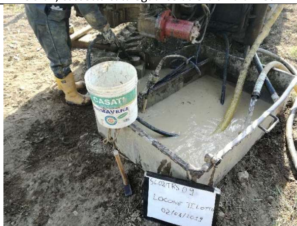
Prova di permeabilità
