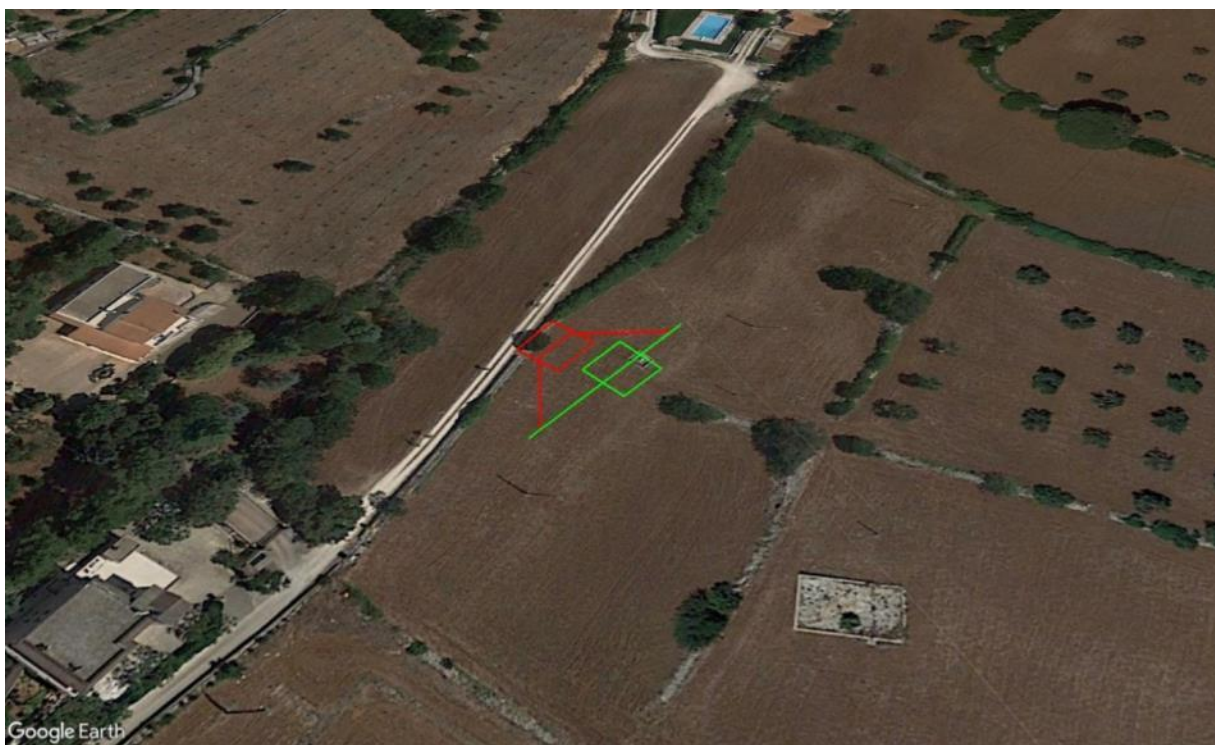
Fig. 7-C. Localizzazione dell'Int. 6 - Variante per rifacimento PIDI 4500480/6 di Putignano (BA), interferenza indiretta. In rosso impianto in progetto, in verde PIDI 4500480/6 da porre fuori esercizio.
