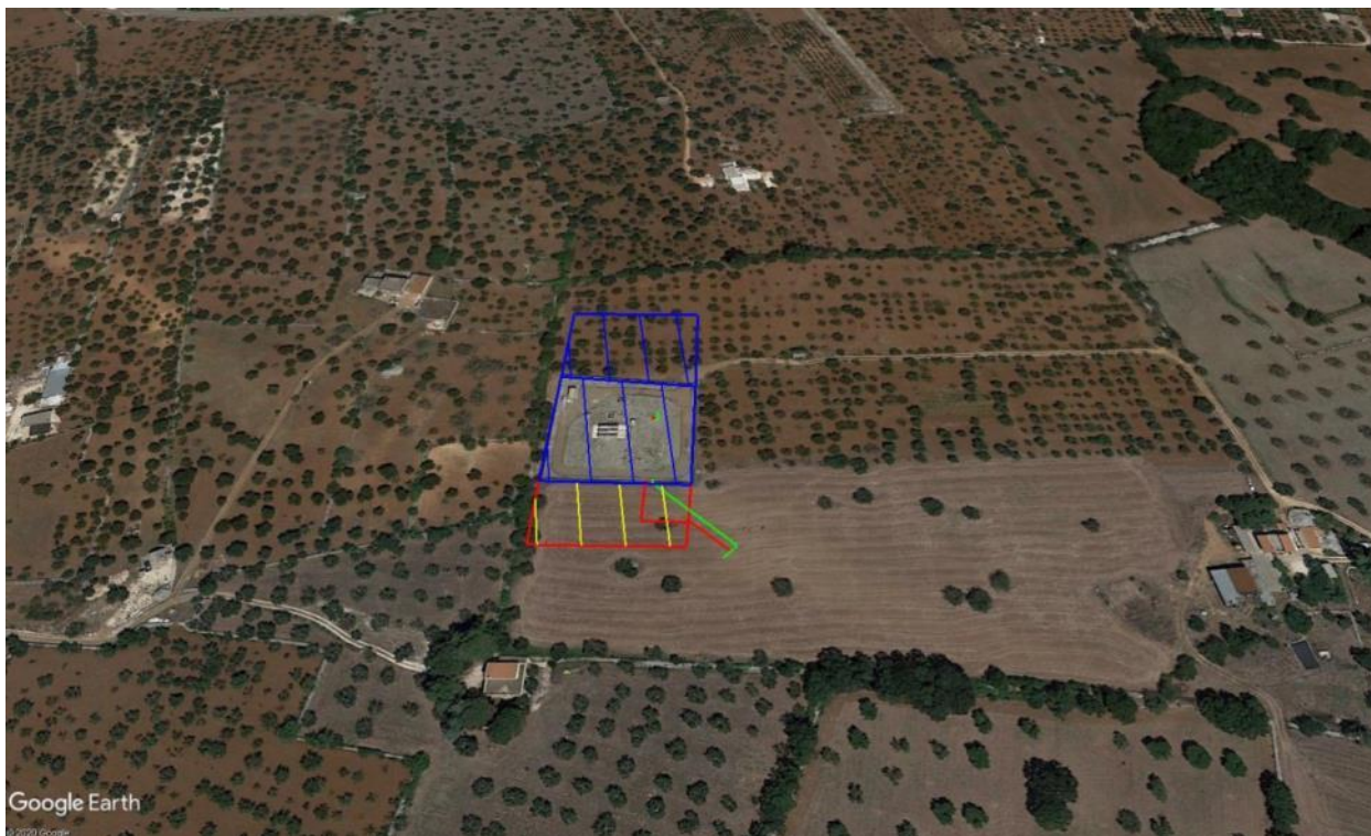
Fig. 7-D. Localizzazione dell'int. 7 - variante per inserimento stazione di ricevimento PIG in prossimità dell'area impiantistica A.I. 20/A in Comune di Castellana Grotte (BA), interferenza indiretta. In rosso nuova area trappola in progetto, in blu impianto di regolazione A.I. 20, in esercizio, ed impianto HPRS 50 (75/24 bar), in fase di realizzazione.
