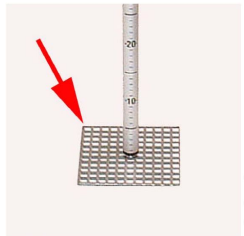
Fig. 4.4: Paletto premarcato tipo per misurazione variazioni fondale
