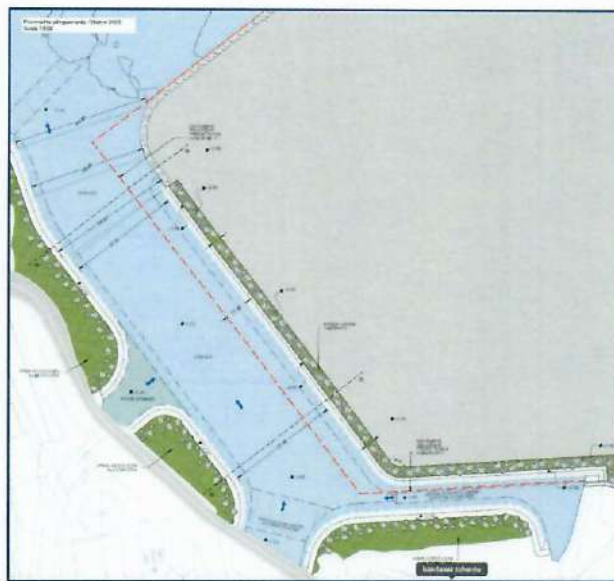
Modifica del "nuovo canale" proposto quale nuovo layout della cassa di colmata durante la riunione del 5/10/2020
