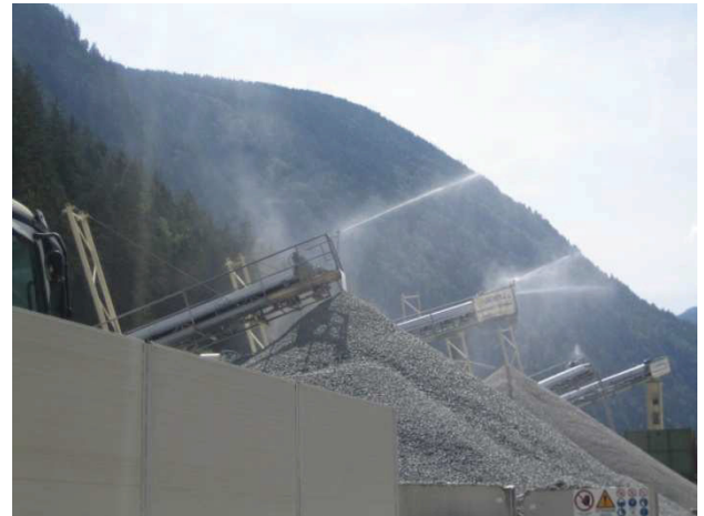
Sistema di umidificazione dei cumuli presso l'impianto di smistamento inerti
