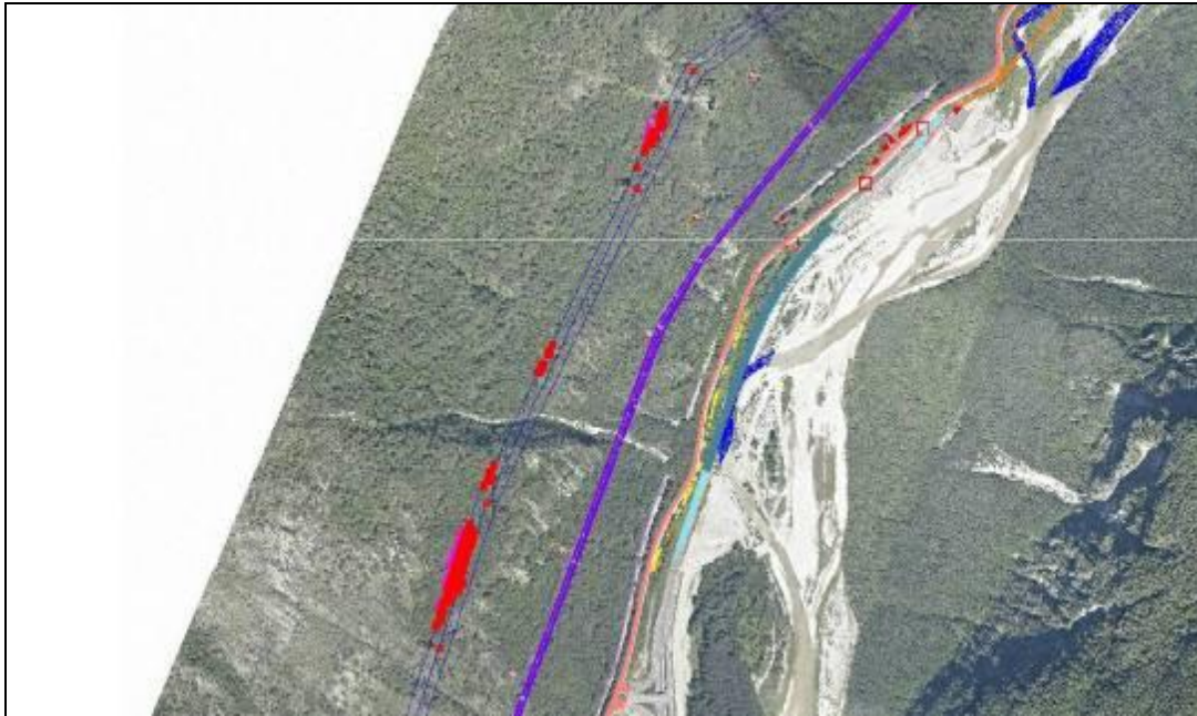
Figura 6-12 Esempio di area di interferenza (area rossa) tra vegetazione forestale e campate calcolata con il metodo LIDAR
