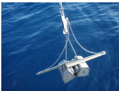
Fig. 2.4 – Benna Van Veen utilizzata per le indagini sulla comunità bentonica.
