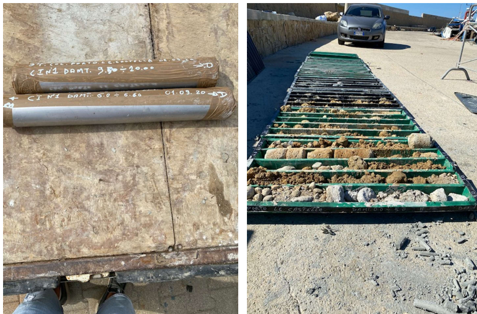
Figura 7.2 Particolare di cassette catalogatrici e campioni indisturbati in fustelle (tipo Shelby)
