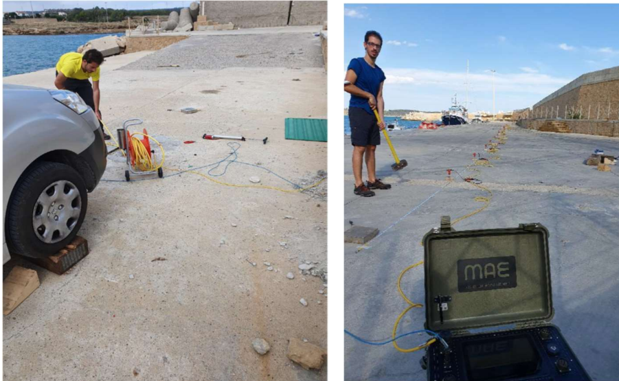
Figura 7.5 Esecuzione prova Down Hole (a sinistra) e sismica a rifrazione (a destra) su Stazione ST)
