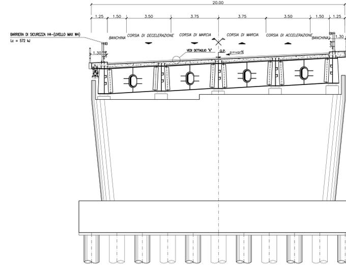
SEZIONE TIPO IN VIADOTTO ASSE PRINCIPALE
