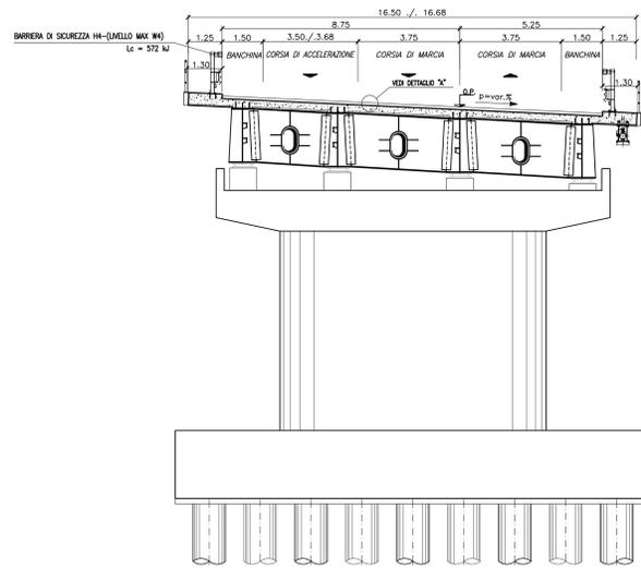
SEZIONE TIPO IN VIADOTTO ASSE PRINCIPALE
