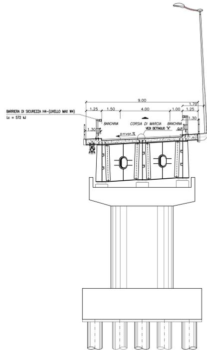
SEZIONE TIPO IN VIADOTTO PER VIABILITA'
