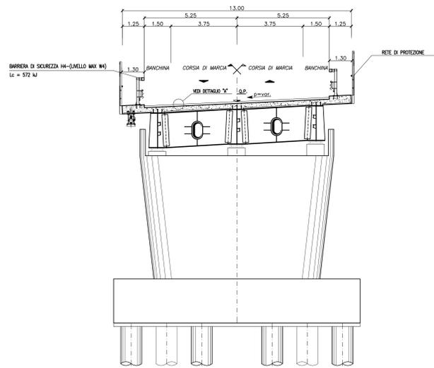
SEZIONE TIPO IN VIADOTTO ASSE PRINCIPALE CON CORSIA DI ACCELERAZIONE
