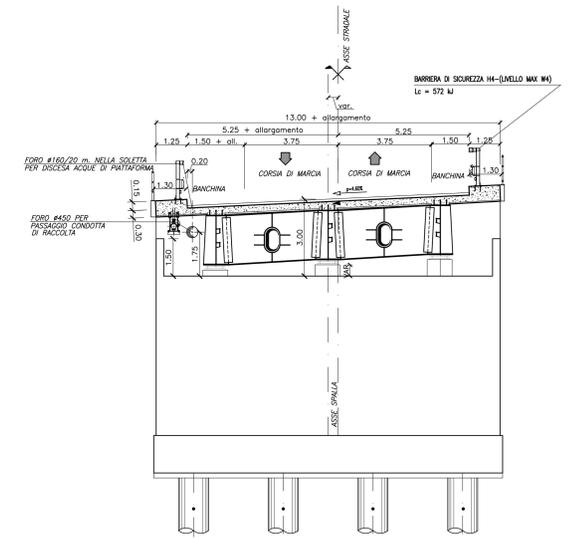
SEZIONE TIPO IN VIADOTTO
